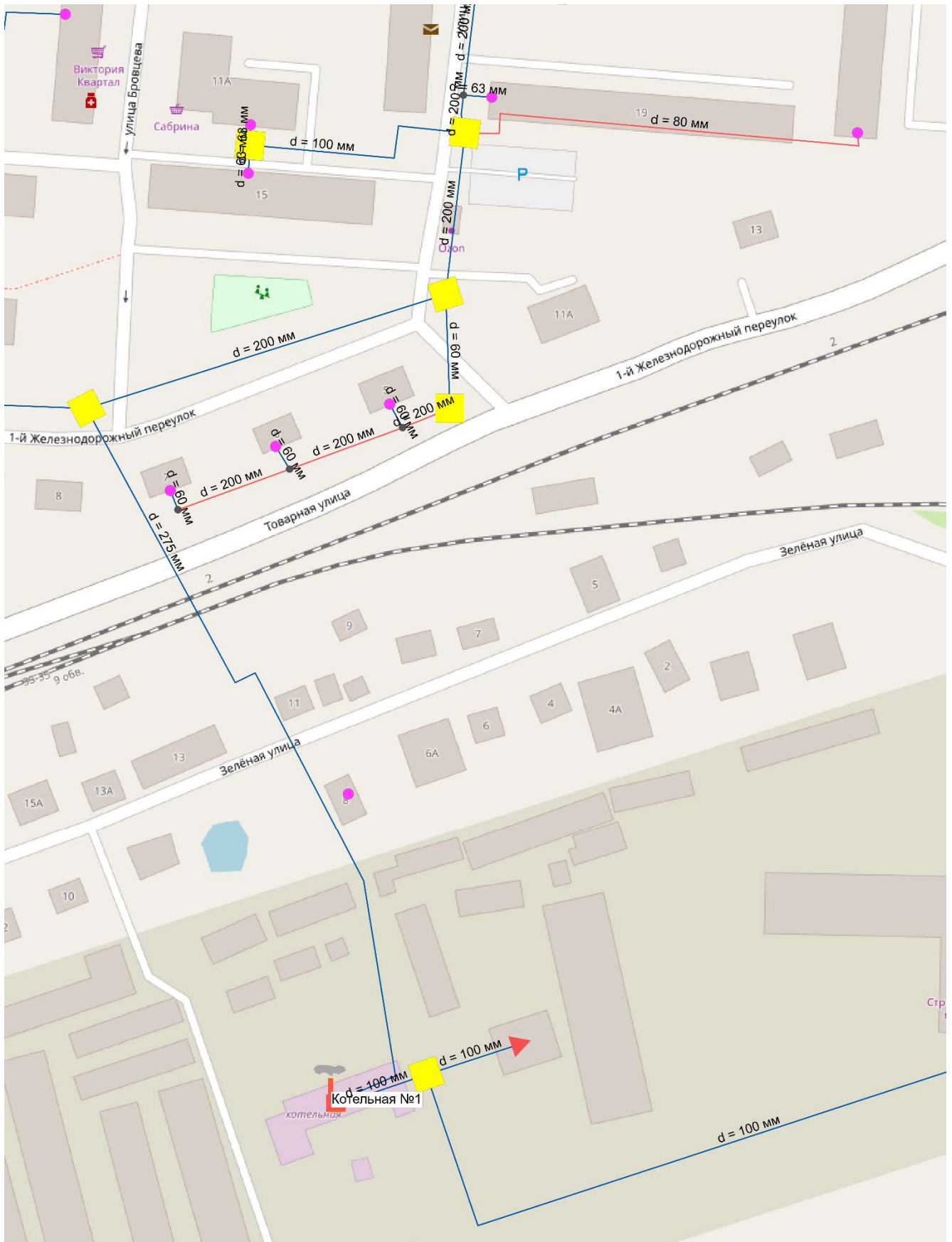
Рисунок 17 Реконструируемые участки тепловой сети котельной №1
