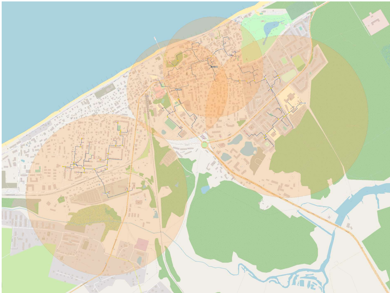
Рисунок 9 Эффективный радиус теплоснабжения котельных г. Зеленоградск
