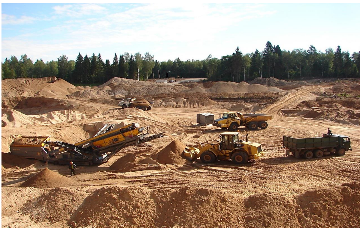
Рис. 5.1. Добыча песчано-гравийных материалов на месторождении в Калининградской области
