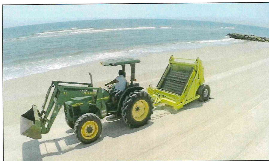
Рисунок. 17. Машина для уборки пляжа Barber SURF RAKE Модель 600HD
