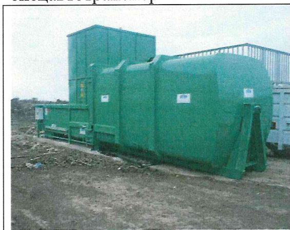
Рисунок 10. Стационарный (моноблочный) компактор
