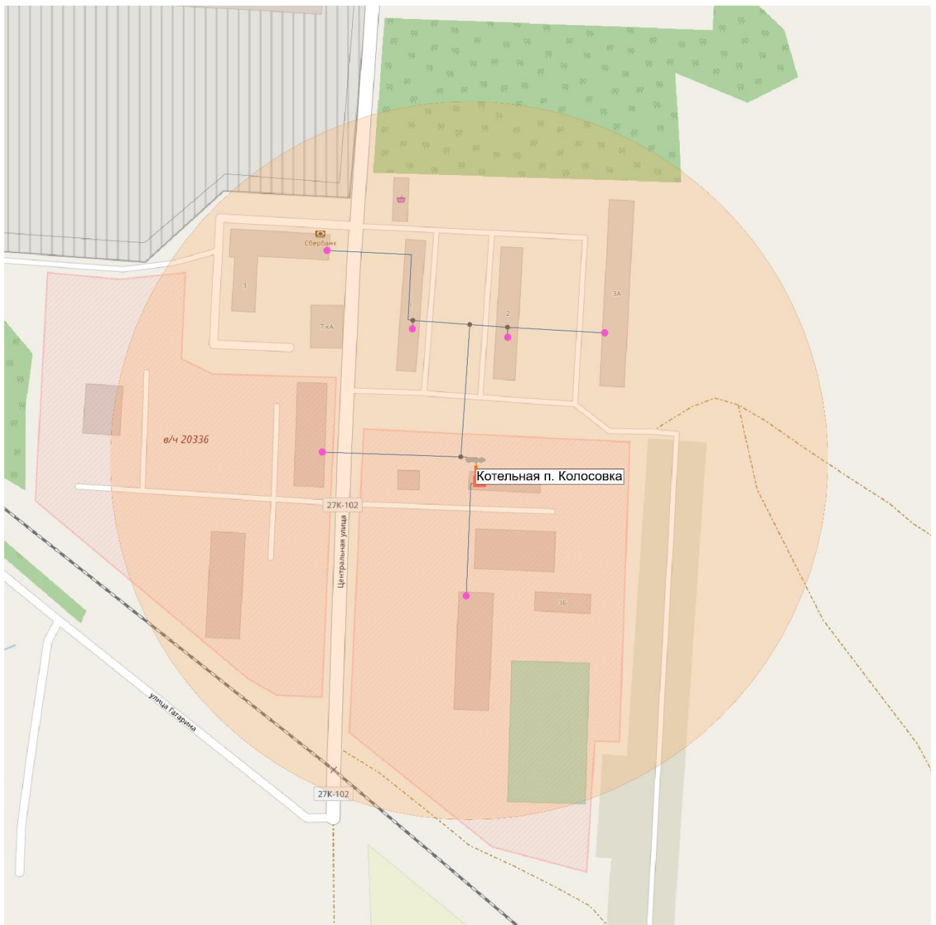
Рисунок 39 Эффективный радиус теплоснабжения котельной п. Колосовка
