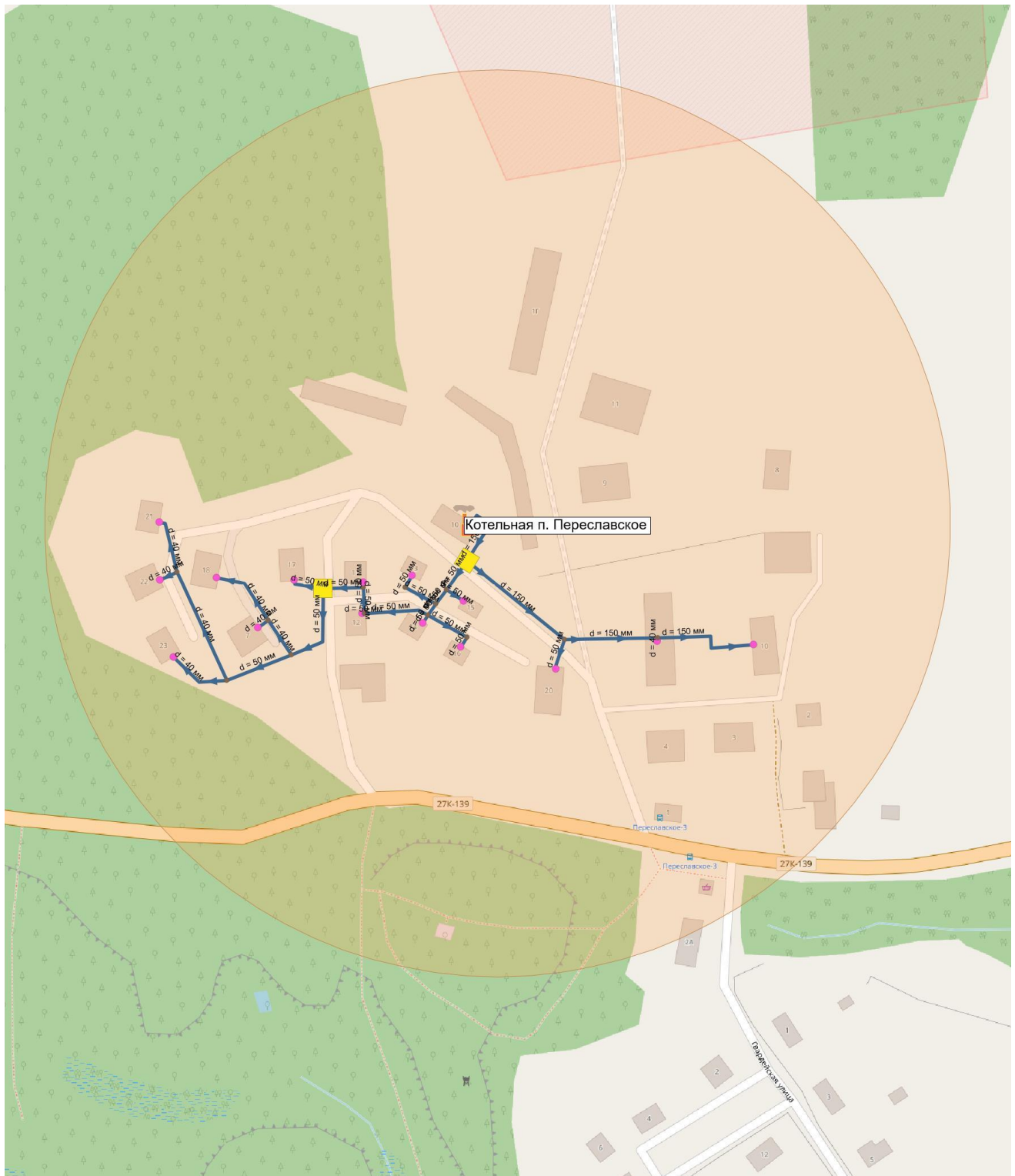
Рисунок 38 Эффективный радиус теплоснабжения котельной п. Переславское
